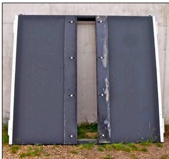
Abb. 1.17: Schütztafel mit verstellbarem vertikalen Schlitz (Öffnungsbreite hier 40 cm).
