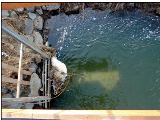
Abb. 2.8: VAKI-Fischzähler am Auslauf des Umgehungsgerinnes; unten: im eingetauchten Zustand.
