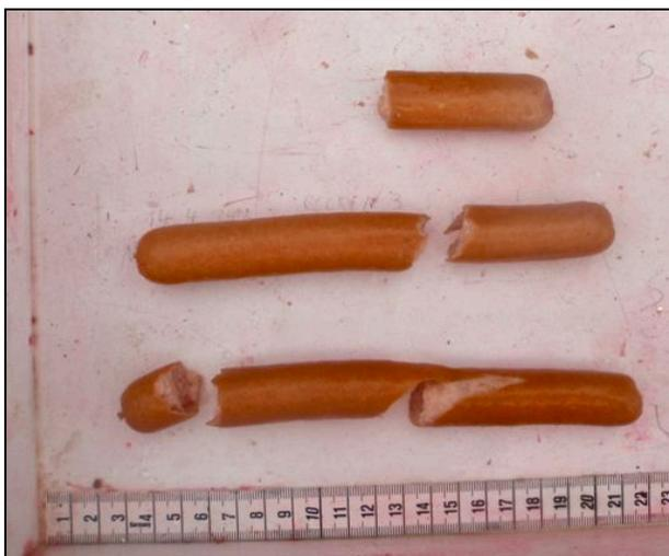
Abb. 4.70: Dummys (Bockwürste) mit charakteristischen Turbinenschäden.
