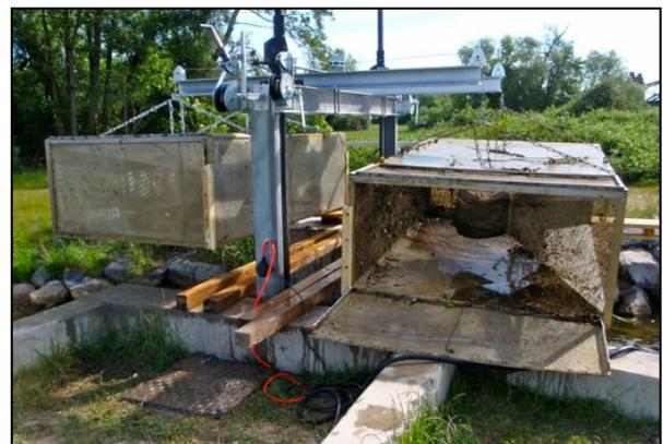
Abb. 2.6: Die 5 mm-Lochung machte eine intensive und häufige Wartung der Kastenreusen notwendig.
