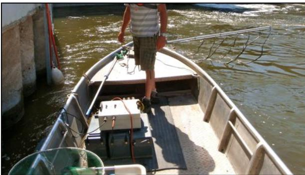
Abb. 2.3: Aggregat (Mitte) und Streifenanode am Bug.
