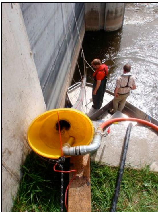
Abb. 2.28: Vorrichtung zum Einsatz der Lachssmolts in den Hamen.
