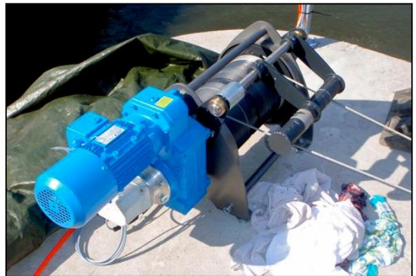
Abb. 2.14: Doppelseilwinde zum Heben und Ablassen des am Stahlrohr fixierten Hamennetzes.
