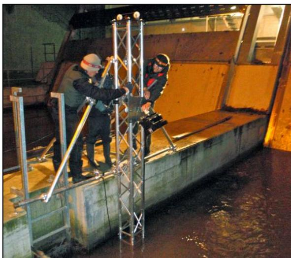
Abb. 2.11: Aufbau des DIDSON-Sonars vor dem Auslauf Umgehungsgerinne (oben) und vor dem Rechen im Oberwasser (unten).
